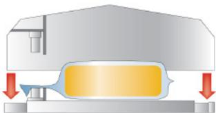
Пакет с продуктом помещаются в камеру или на транспортер, который продвигает продукт в камеру. Камера закрывается вручную или автоматически. После закрытия камеры начинается процесс вакуумирования.
